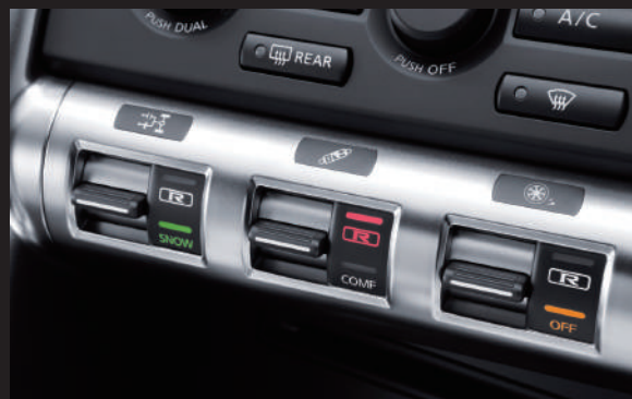
儀錶板中央搭載了設定開關。可以在行駛中更改車輛設定，例如正常模式或雪地模式等。
