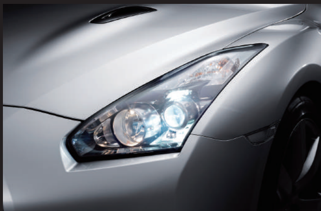
新增3片輔助反光板，裝備了新開發的超廣角頭燈，可以廣泛照亮側面。
