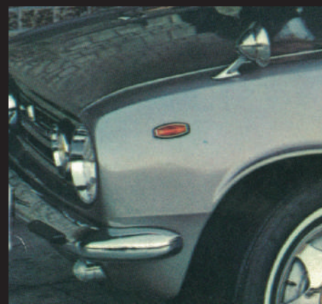
車身設計也融入了多項嘗試，例如首次在國產車上搭載閃光燈。
