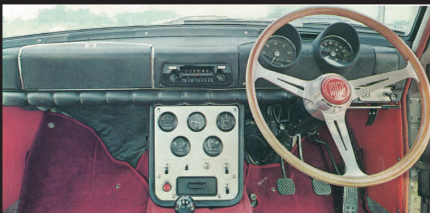
1600GT的儀錶板將速度計和轉速計配置在方向盤正前方，並將開關設計在中控台上。
