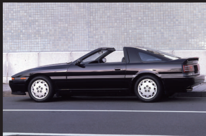
車頂拆卸後的Aerotop，採用四顆螺絲固定，拆卸後的車頂可整齊收納於行李廂。
