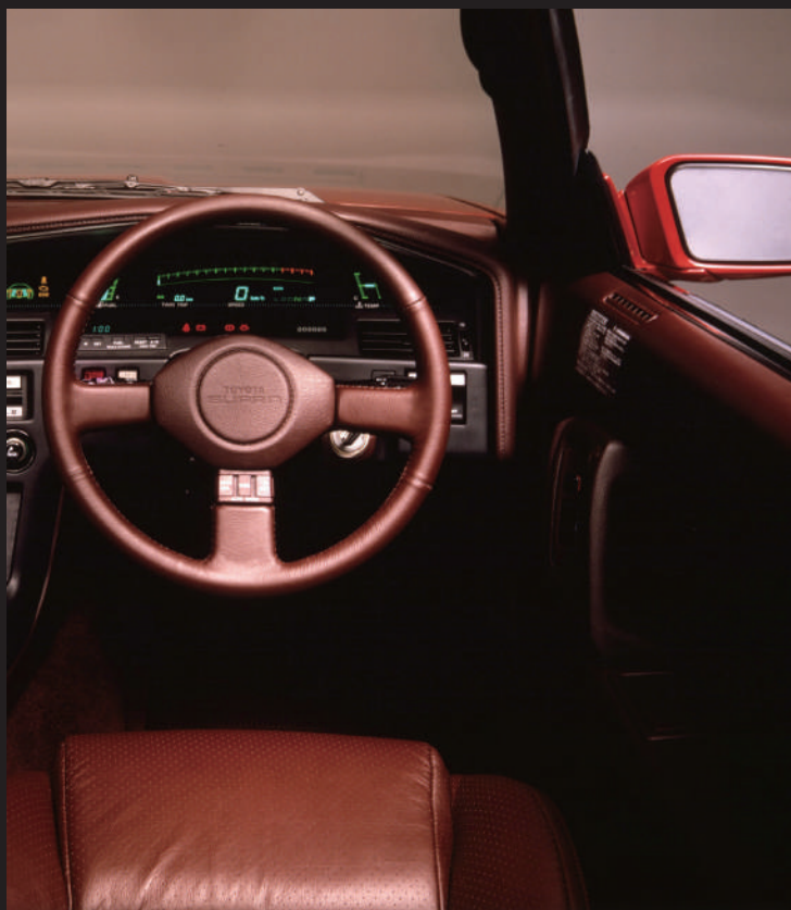
3.0GT TURBO的儀錶板周圍。標配了全景式數位儀錶，去除了儀錶指針，以4種顏色的儀錶顯示行駛資訊。GT TWIN TURBO則為選配。
