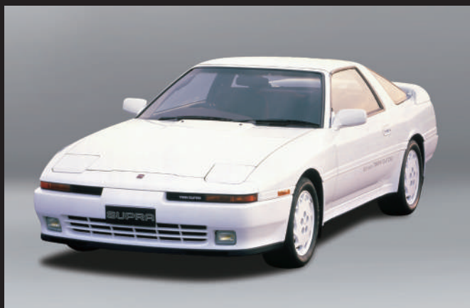
平成元年車款。受汽車稅制改革影響，2000cc DOHC渦輪增壓車款也導入寬體車身，當時多數銷售車款皆為3號車型。
