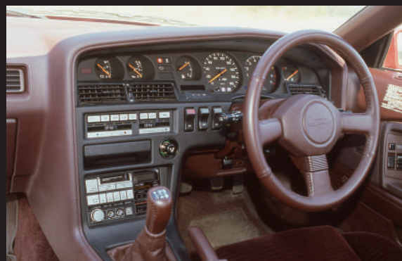
這是GT TWIN TURBO的儀錶板周圍。採用了橫向排列的大型類比儀錶共六個。3.0GT TURBO和GT TWIN TURBO的方向盤均為真皮包覆，其他車型則為聚氨酯。
