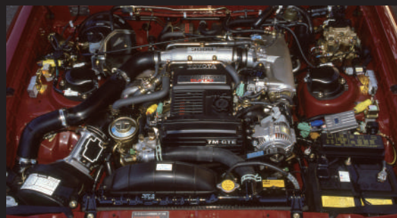
3.0GT TURBO的引擎室。採用了8.4的高壓縮比設計，從低轉速到高轉速，提高了熱效率。透過渦輪增壓器和空冷式中冷器實現了高輸出。
