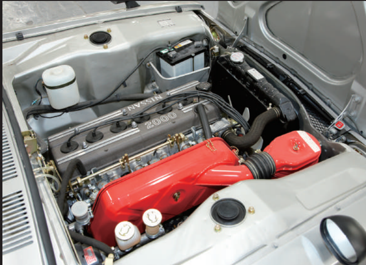
第一代2000GT-R搭載S20引擎。被稱為「賽車引擎的公路版本」，表現出如此高性能，以至於據說光是引擎就佔據了車輛價格的一半。車蓋是前鉸鏈式的，須從後方打開。
