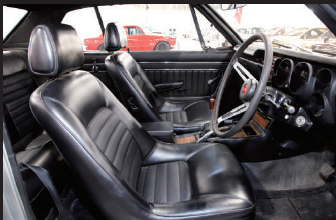
駕駛座和副駕駛座採用固定角度的桶型座椅。硬頂車型中，前座可整體向前倒，以便進入後座。
