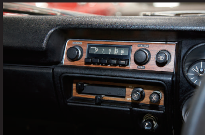
上面是選配的AM收音機。下面是硬頂車型的標配，可使用加熱器的空調控制部分。
