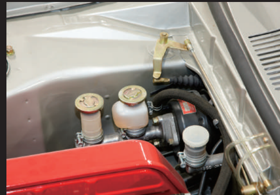
在照片右後方可見的裝置是增壓制動器，用於增加制動力，可選配安裝。
