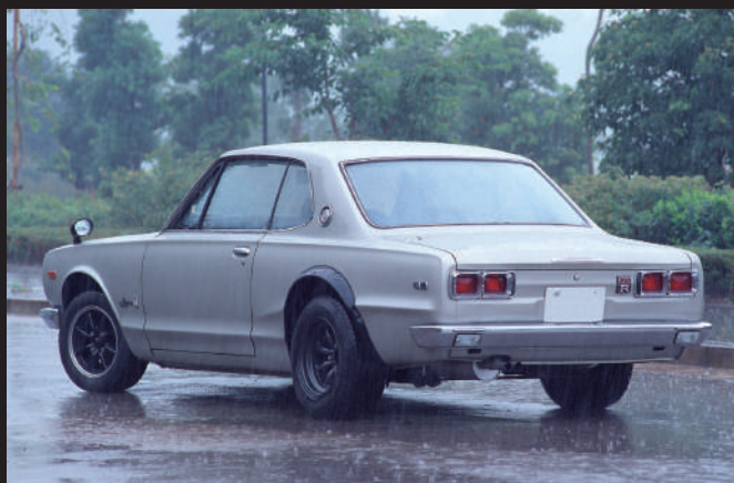
硬頂車款的後視圖。方形的4連尾燈是所有GT-R車型中的第一代。
