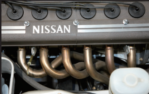
將3個汽缸併成一個不鏽鋼的等長排氣歧管，呈現出複雜的曲線。
