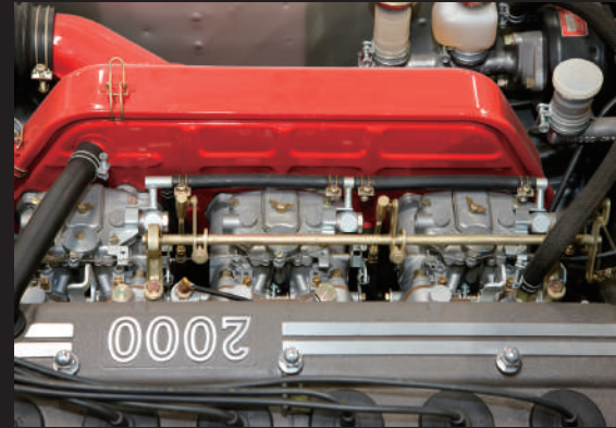
有3個Solex化油器。每個化油器都有兩個油門閥，因此總共有6個油門閥，具有與賽車相當的規格。
