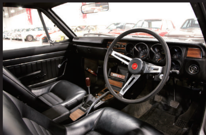
儀表板周圍。在照片上的硬頂車型中，方向盤後面有6個計量儀表。而在4門轎車中，兩個計量儀表分散在中控台上。
